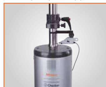
Kontrola páčkové sondy (indukční sondy)
