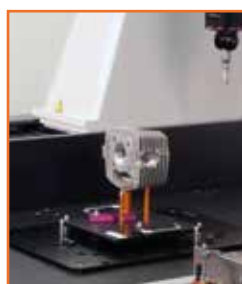
K551218: Aplikace systému spodní upínací palety
