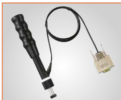
Dopadové zařízení HLD + 15 UD-413 Použití pro konkávní obrobky, jako jsou ozubených kol, kuličková ložiska atd.
