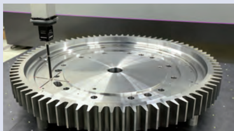
Skenování s hlavou SP80 a dotekem délky 100 mm.
