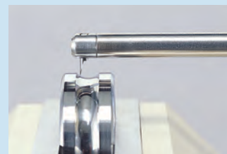
Měření vnitřního/vnějšího prstence kontury ložiska
