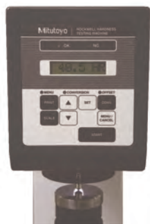
Funkce volby zkušebního předzátížení
