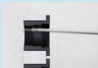
Měření oboustranným snímacím hrotem pro měření nahoře a dole
