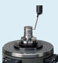
Měření rohovým dotekem
