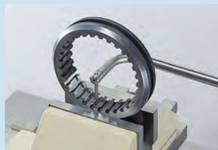
Měření vnitřního ozubení
