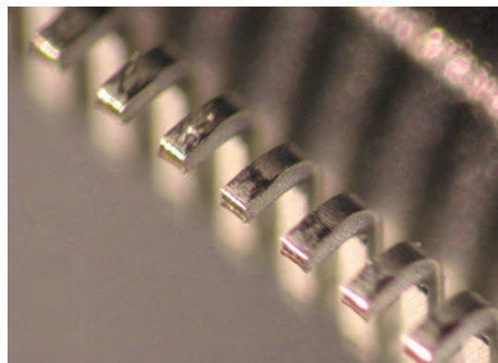
Příklad měření: Výška nožiček na QFP obalu
