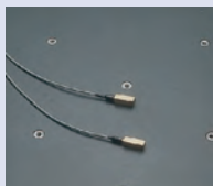
Systém teplotní kompenzace (detail teplotních čidel)
