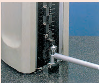
Příklad referenčního nastavení dutinoměru
