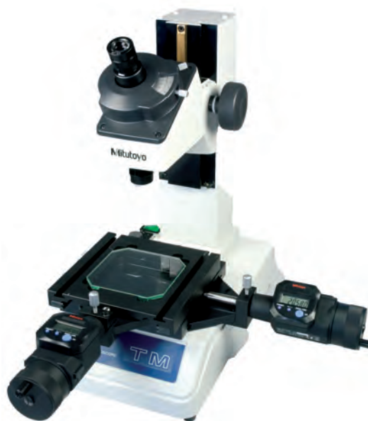
TM-505 vybaven digimatic vestavnými mikrometrickými hlavicemi (zvl. příslušenství).
