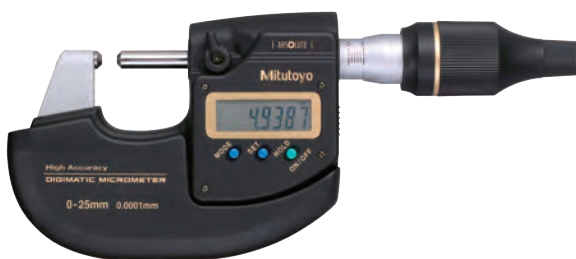
Vysoce přesný mikrometr s teplotní úchopovou ochranou (standardní příslušenství)
