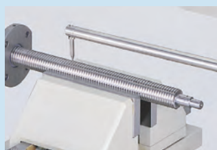
Měření tvaru vnějšího závitu
