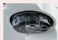
Motorický karusel se 2 vnikovými tělíska a 4 objektivy
