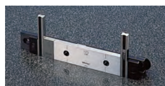
Držáky B a C: Používají se pro spojení dvou dlouhých koncových měrek dohromady s další koncovou měrkou do 35 mm (držák B) nebo 140 mm (držák C). Také se používají pro uchycení čelistí se dvěma adaptéry.
