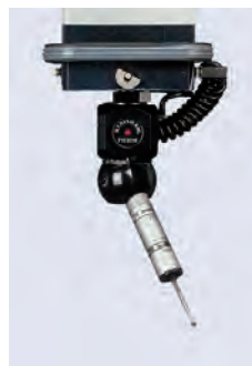
SP25M při průměru pouhých 25 mm je SP25M malá a lehká a ideální pro montáž na otočné hlavy. Je také dostatečně kompaktní pro použití na malých SMS.
