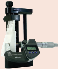
Micro Checker 516-607 použitelné sady koncových měrek 516-156, 516-157, 516-158
