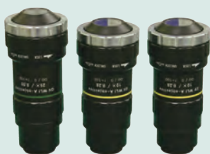
QV WLI Objektivy Zvětšení 10X: Zorné pole 0,32 x 0,24 mm Zvětšení 25X: Zorné pole 0,128 x 0,096 mm Zvětšení 5X: Zorné pole 0,64 x 0,48 mm
