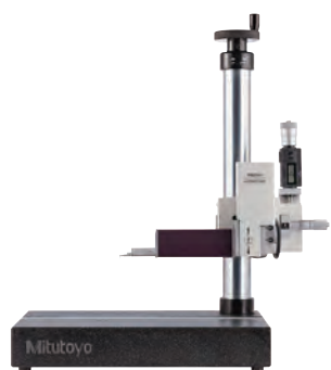
SJ-411: 207,5 mm / SJ-412: 234 mm Měřicí jednotka
