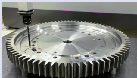
Skenování s hlavou SP80 a dotekem délky 100 mm.
