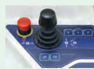
Ovládací panel s joystickem pro rychlé posuvy a tříosé najíždění.
