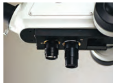
Použití typu karuselové hlavy se 2-bajonety. (Tovární nastavení prováděné na přání).
