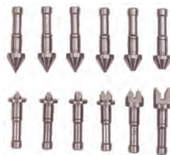
Provedení výměnných doteků/vřeten v odpovídajících párech
