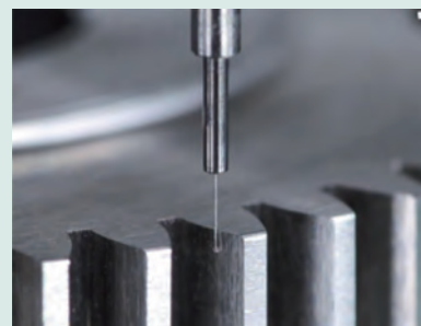
MPP-NANO Module 0,8 měření hlavního ozubení
