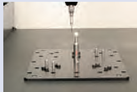
Upínací deska a kalibrační koule na granitové desce stroje.
