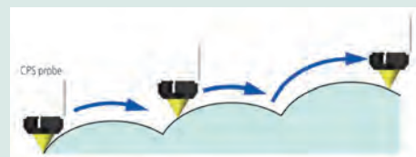
Měření skenováním s automatickým pojezdem v ose Z.
