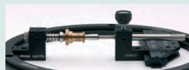
Držení válcového dílu mezi upínacími hroty.
