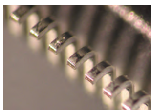
Příklad měření: Výška nožiček na QFP obalu
