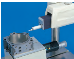
Měření v hlubokých drážkách
