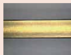
Vodící drážka potažena vrstvou titanu
