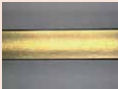
Vodicí drážka potažena vrstvou titanu
