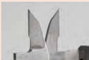
Měřicí čelisti osazené tvrdokovem
