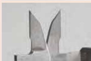
Měřicí čelisti osazené tvrdokovem
