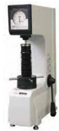
HR-110MR Tvrdoměr Rockwell Model šetrný vůči životnímu prostředí. Základní operace jsou všechny prováděny manuálně, včetně změny závaží (zvolení celkového zkušebního zatížení).
