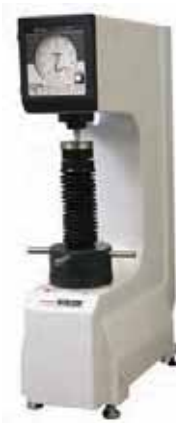
HR-210MR Tvrdoměr Rockwell Manuální změna závaží (s volbou celkového zkušebního zatížení) a ruční zkušební předzatížení. Motorické řízení kontroly pořadí zatížení.
