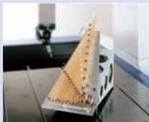
Kalibrace SMS pomocí skleněné měřky s virtuálně nulovým koeficientem teplotní roztažnosti.
