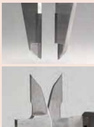
Měřicí čelisti osazené tvrdokovem
