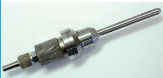
Trn pro měření sedla ventilu
