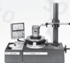
MMQ 2 - kompaktní stolní Formtester na vyhodnocení kruhovitosti
