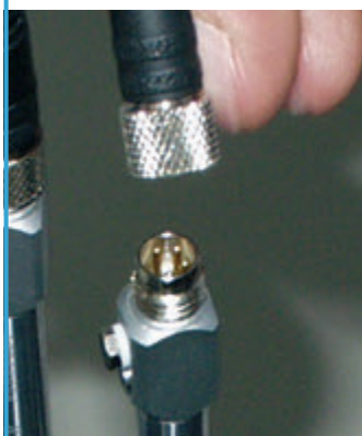
Kabel a snímač lze rozpojit díky konektoru
