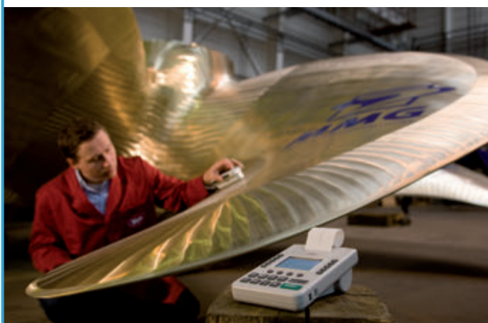
Měření drsnosti povrchu lodních šroubů (společnost Mecklenburger Metallguss)
