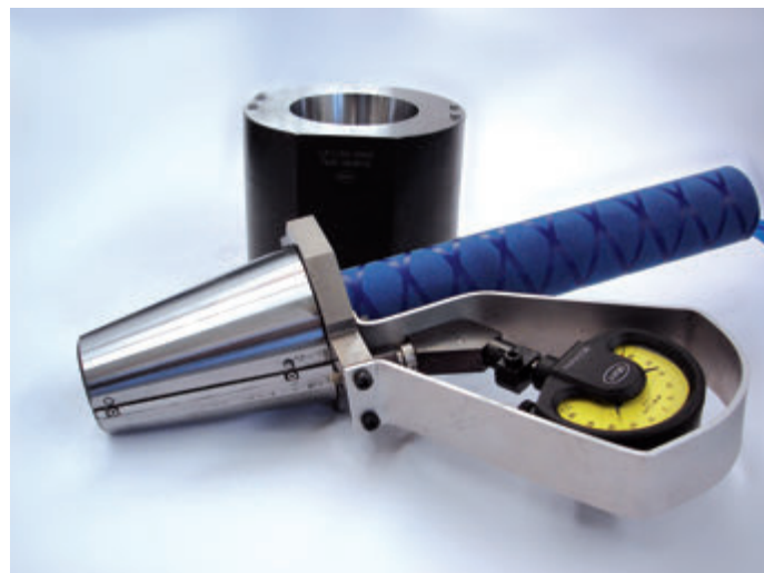
Kuželový měřicí trn s měřením hloubky uložení
