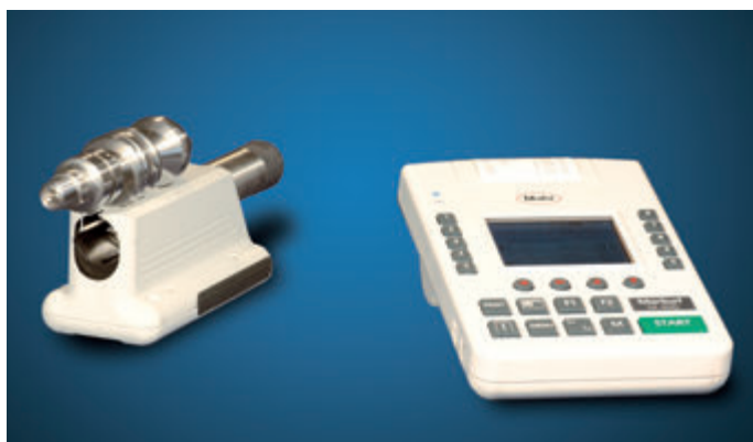
Měření v pozici vzhůru s využitím prizmatu Automatické nastavení nuly na BFW-250
