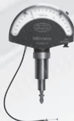
Millimes přesný úchylkoměr z r. 1937 - první zobrazovací přístroj pro spolehlivé určení rozměrových rozdílů 1/1000 mm
