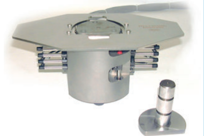
Elektronický vícesnímačový měřicí přípravek pro měření \varnothing (6x) a kolmosti
