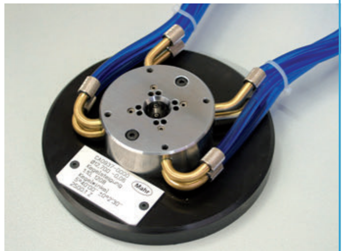
Kuželový vzduchový kroužek se dvěma měřicími body ve dvou rovinách pro měření \varnothing (4x), úhlu kužele (2x), stoupání kužele (2x)
