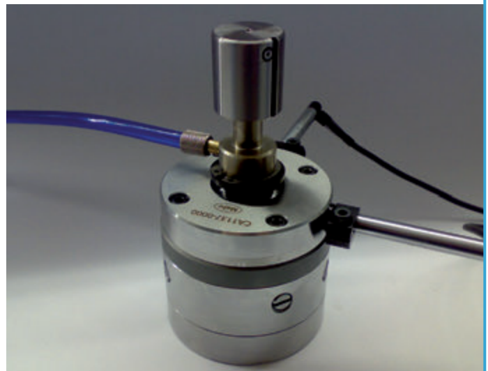
Plovoucí vzduchový trn se snímáním polohy pro měření průměru a polohy
